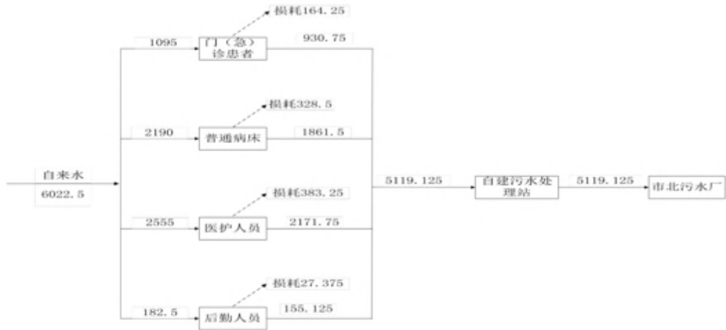
图 3-5 本项目环评审批水平衡图(单位: t/a)
